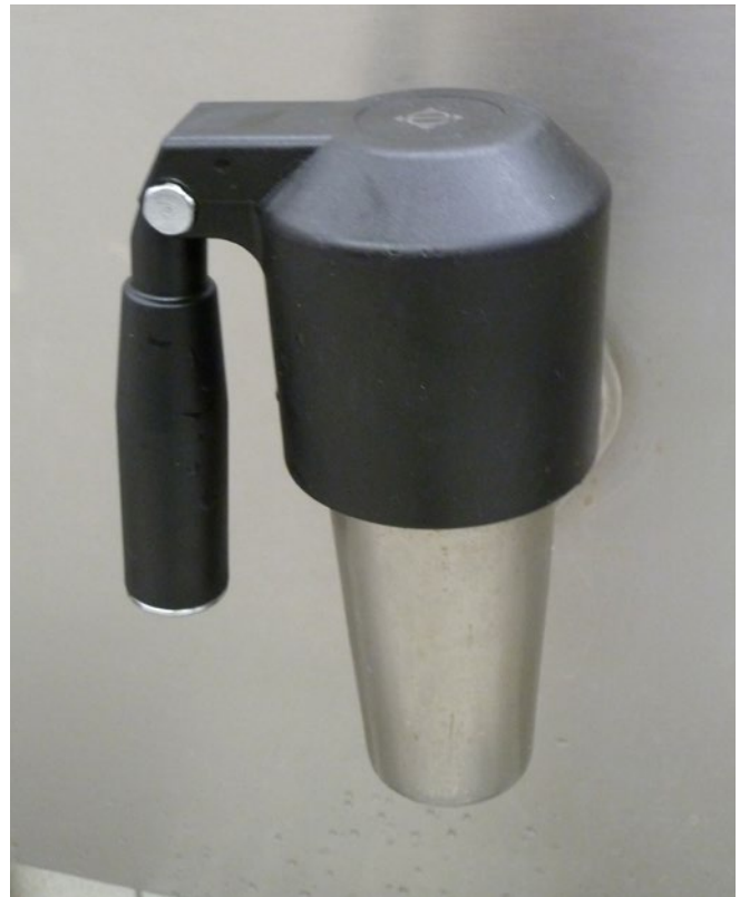
Abb. 14 Klappgriff eines Kochkessels in Schließstellung – ein unbeabsichtigtes Öffnen ist nicht möglich
